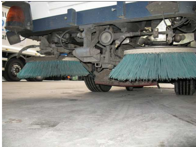
Figuur B3.5 Slijtage aan de borstels. De rechter borstel (voor de kijker links) veegt meer langs stoepranden
