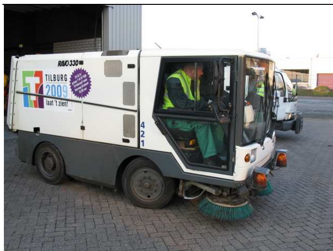
Figuur B3.4 De ergonomie van deze veegmachine is niet ideaal. De machinist moet gebogen in het voertuig zitten
